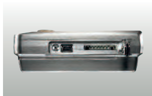
Разъем для подключения Мини-USB кабеля и SD- карты
